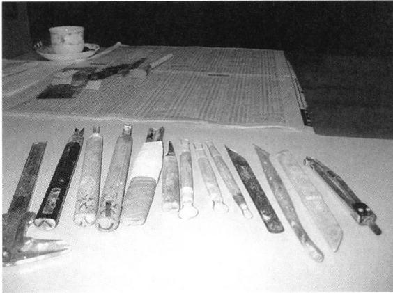
図9 原型製作用の各種道具
