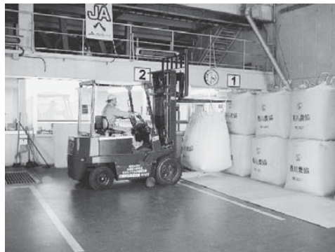
写真2 フレキシブルコンテナによる効率化
