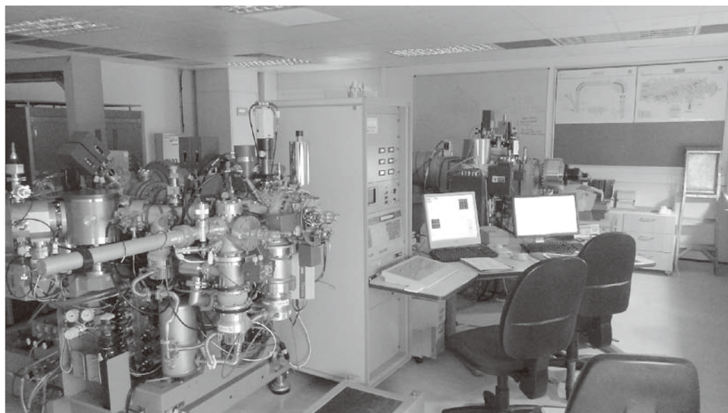
図4 Secondary Ion Mass Spectrometry (SIMS) (2次イオン質量分析装置) CAMECA社製「IMS1270」。左側がSIMS本体、右側がオペレートPC。
